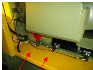
spínače priblíženia „šmýkadla lisu“
